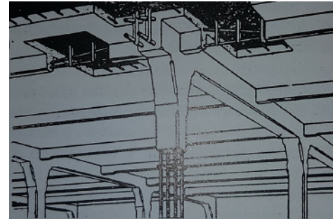
Εικ. 46: Hennebique, σπλισμένο σκυρόδεμα, 1892.
