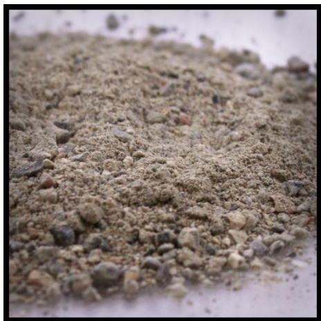
Εικόνα 10: Άμμος από ανακυκλωμένα αδρανή
