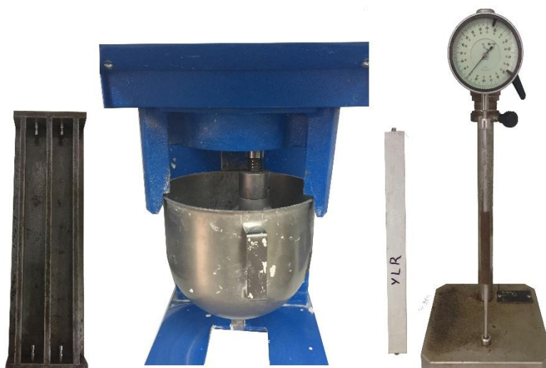
Εικόνα 22: Εξοπλισμός για την μελέτη γραμμικής συρρίκνωσης στο εργαστήριο της Ερευνητικής μονάδας: Έλεγχος Ποιότητας Υγιεινή και Ασφάλεια στην Μεταλλευτική (ΕΠΥΑ)
