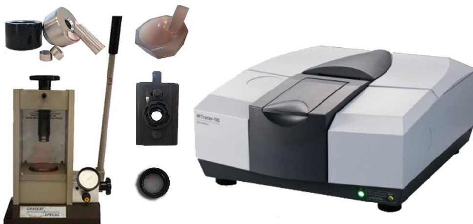
Εικόνα 16: Εξοπλισμός που χρησιμοποιείται για την δημιουργία pellets και εξαγωγή αποτελεσμάτων της εξέτασης FTIR
