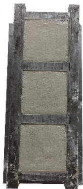
Εικόνα 20: Κυβικές μήτρες 5x5x5 cm για την μελέτη μονοαξονικής θλίψης
