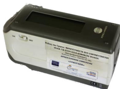
Εικόνα 19: Συσκευή χρωματόμετρου που χρησιμοποιείται στο εργαστήριο ΥΛΠΟΚ.
