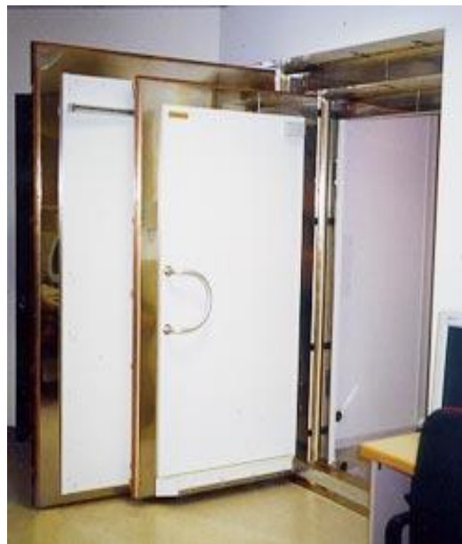
Εικόνα 3.3 Η είσοδος σε ένα μαγνητικά θωρακισμένο δωμάτιο (MSR), παρουσιάζοντας τα διαφορετικά επίπεδα θωράκισης.
