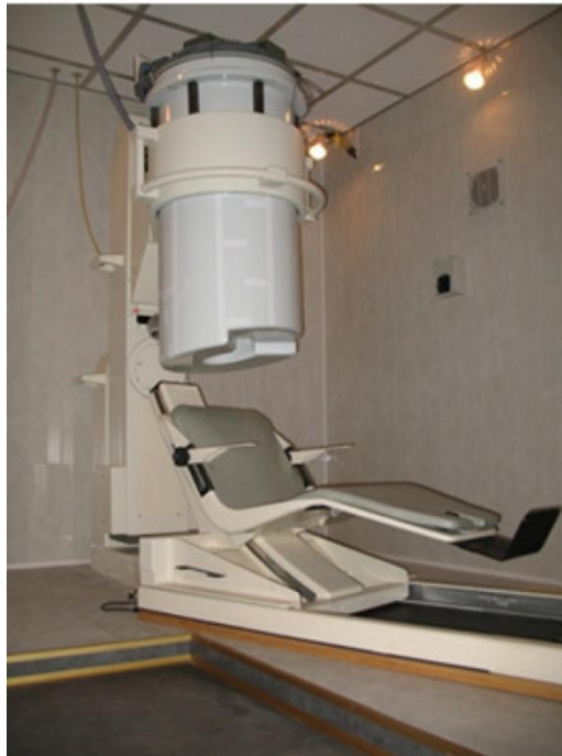
Εικόνα 3.2 Το ΜΕΓ σύστημα καταγραφής μέσα στο μαγνητικά θωρακισμένο δωμάτιο.
