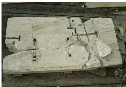
Εικόνα 1.6: Θραύση μέλους λόγω διόγκωσης οξειδωμένων συνδέσμων από προηγούμενες αναστηλωτικές επεμβάσεις. © Αρχείο ΥΣΜΑ
