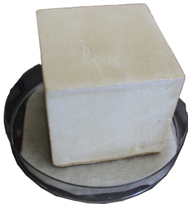
Εικόνα 4.12: Δοκίμιο κατά τη μέτρηση της τριχοειδούς αναρρίχησης (πηγή: προσωπικό αρχείο)
