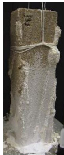
Εικόνα 1.8: Διάβρωση λόγω κρυστάλλωσης των αλάτων (πηγή: Διάλεξη_2_3_Φθορές από νερό και άλατα, Νόνη Μαραβελάκη, Open e-class tuc)
