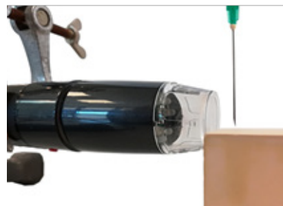
Εικόνα 4.10: Κατασκευή μέτρησης Contact Angle (πηγή: προσωπικό αρχείο)
