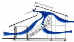
Εικόνα 24: Φυσικός Αερισμός , Πηγή: SgA group engineering &energy constructions
