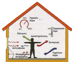
Εικόνα 65: Παράγοντες που επηρεάζουν τη θερμική άνεση. Πηγή: Οικολογική Δόμηση, Διεπιστημονικό Ινστιτούτο Περιβαλλοντικών Ερευνών
