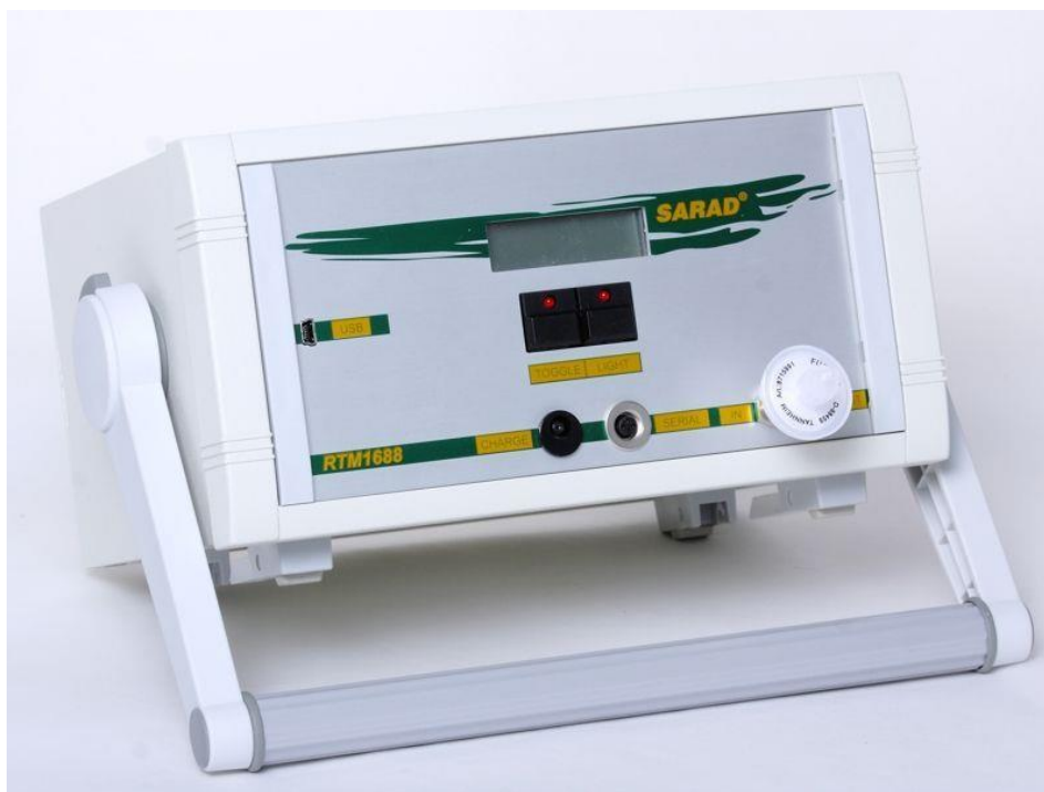
Εικόνα 1.14: Το όργανο RTM1668-2 της Sharad με το οποίο έγινε η μέτρηση του ραδονίου και του θορονίου [7].
