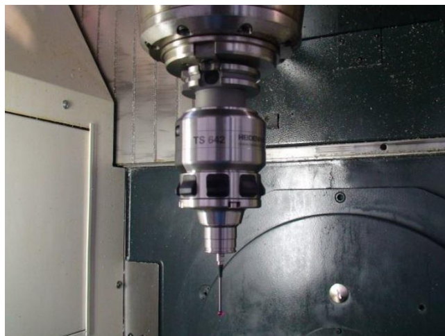
Σχήμα 3.8: Τρισδιάστατος ανιχνευτής ακμών 3D Probe
