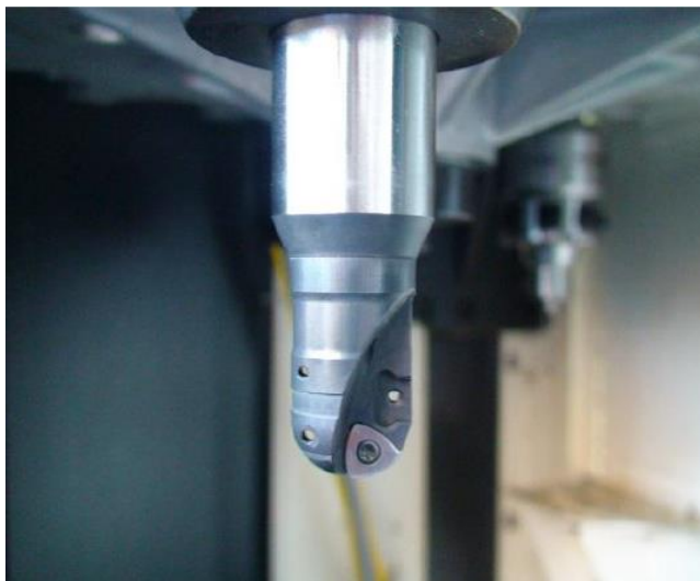
Σχήμα 3.10: Κοπτικό εργαλείο σφαιρικής απόληξης D=20\text{ mm}
