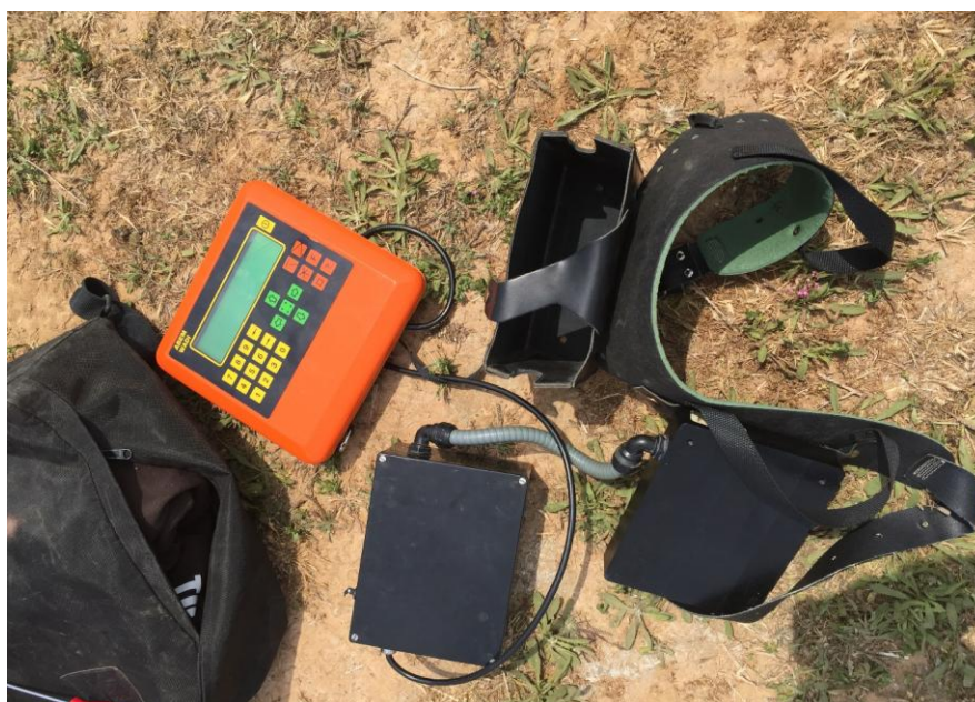
Σχήμα 3.2: Όργανο μετρήσεων VLF (WADI της ABEM), με το οποίο πραγματοποιήθηκαν οι μετρήσεις στην περιοχή της παραλίας στα Φαλάσαρνα.
