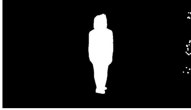
Εικόνα 3.4 Αποτέλεσμα αφαίρεσης του background META την χρήση μορφολογικών αλγορίθμων.
