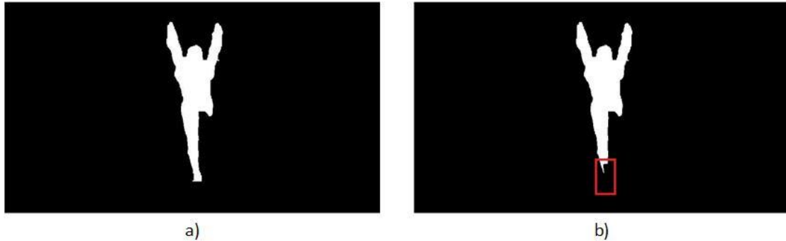
Εικόνα 3.14 Παράδειγμα της εικόνας Upd α) την χρονική στιγμή t και την χρονική στιγμή t+1 b) μια περιοχή της εξαφανίζεται ξαφνικά λόγω αργής κίνησης του αντικειμένου (κόκκινο πλαίσιο).
