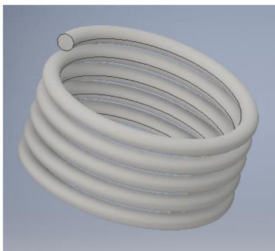
Σχήμα 3.1.14: Εντολή Coil.
