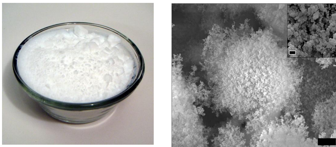
Εικόνα 4.7: Silica fume (αριστερά) και συμπλέγματα silica fume σε ηλεκτρονικό μικροσκόπιο SEM (δεξιά), (Patel et al., 2015)
