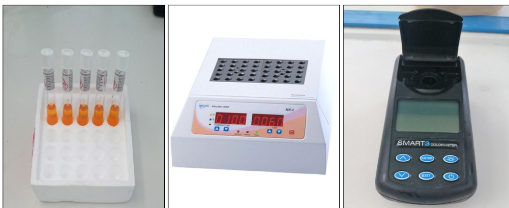
Εικόνα 4.14: Δείγματα υδραργύρου, θερμοαντιδραστήρας και φασματοφωτόμετρο (αριστερά προς δεξιά).
