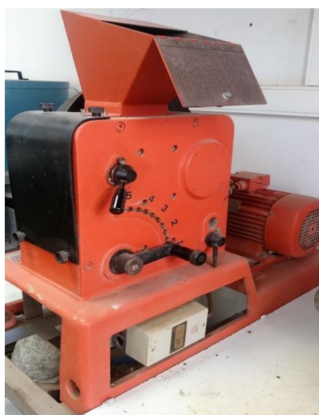
Εικόνα 4.8: Σιαγονωτός σπαστήρας-αναπαράσταση λειτουργίας
