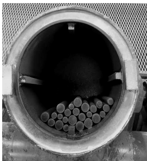
Εικόνα 4.9: Ραβδόμυλος-αναπαράσταση λειτουργίας
