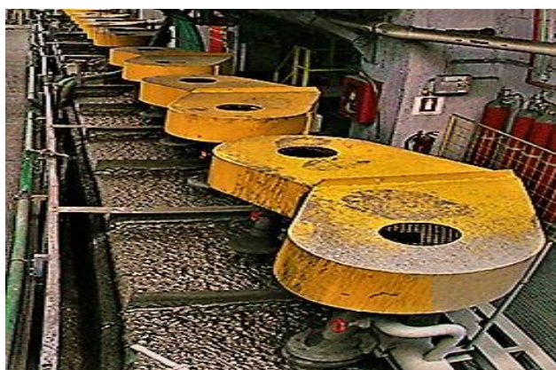
Εικόνα 2 1: Κελί επίπλευσης αφρού εργοστάσιο εμπλουτισμού Ολυμπιάδας (metalleiachalkidiki.gr)
