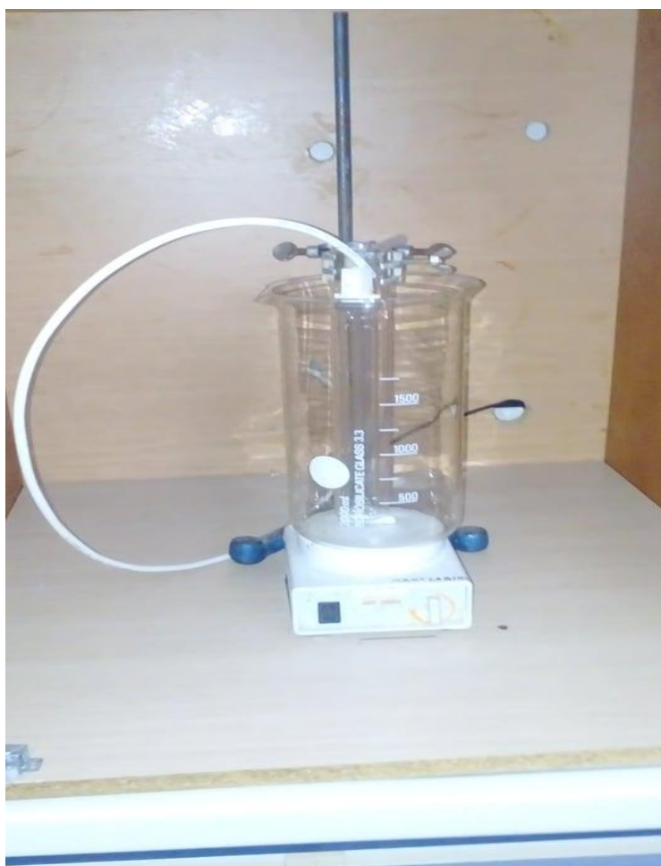
Εικόνα 2.3: Εργαστηριακός φωτοχημικός αντιδραστήρας διαλείποντος έργου (Αντιδραστήρας Β).
