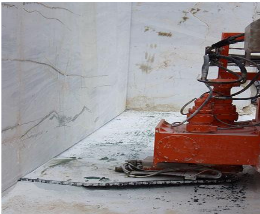
Εικόνα 1.5: Εξόρυξη με αλυσοπρίονο
