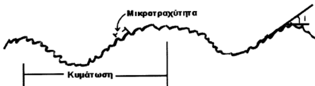
Σχήμα 2.13: Κυμάτωση και μικροτραχύτητα στην επιφάνεια μιας ασυνέχειας (Ρόζος, 2007)
