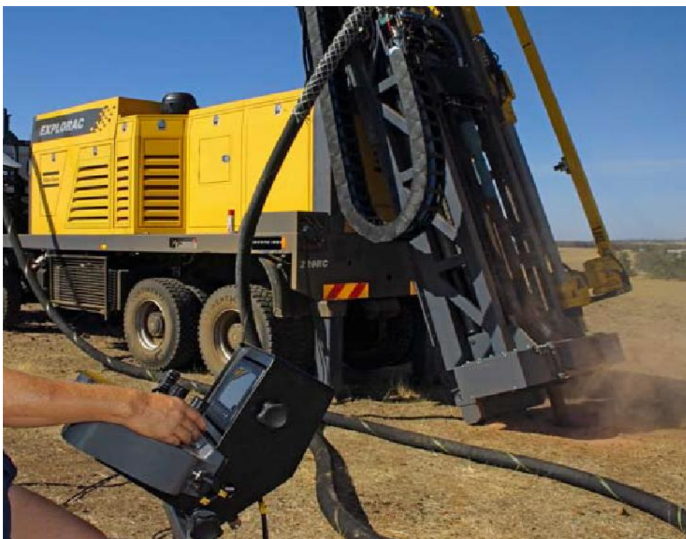
Εικόνα 4.1: Αυτοκινούμενο περιστροφικό γεωτρύπανο για συλλογή πυρήνων με δειγματοσυλλέκτη και αδαμαντοκορώνα
