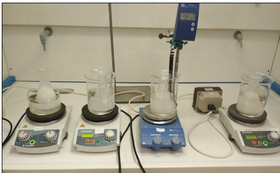
Εικόνα 4.6: Ανάμιξη στη φάση των 16 h των διαλυμάτων με το ενισχυτικό υλικό (τρία αριστερά δοχεία) και του πρότυπου διαλύματος (δεξί διάλυμα)
