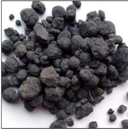
Εικόνα 4.10: Κλίνκερ για τσιμέντο πόρτλαντ (Δομικά υλικά, Τσιμέντο και Σκυρόδεμα, Εθνικό Μετσόβιο Πολυτεχνείο)
