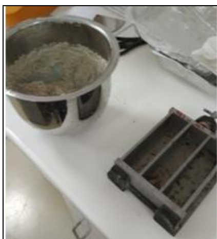
Εικόνα 4.19: Τελική τοποθέτηση υλικού στις μήτρες
