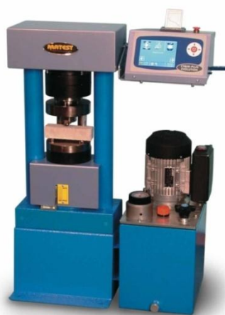
Εικόνα 4.23: Συσκευή θραύσης δοκιμίων 40x40x160 mm
