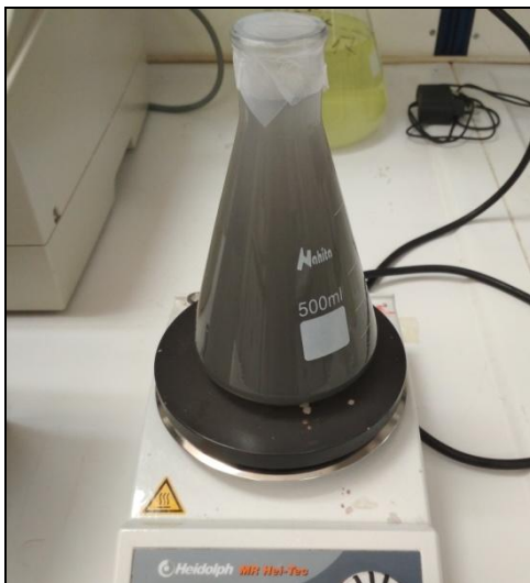
Εικόνα 4.7: Διάλυμα micrtosilica/silicafume μετά την προσθήκη διαλύματος ζάχαρης κατά την ανάμιξη 15 min
