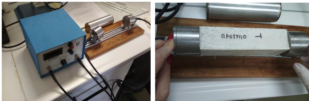
Εικόνα 4.22: Μετρητής χρόνου διάδοσης υπερηχητικών παλμών (αριστερά), μέτρηση χρόνου διάδοσης πρότυπου δοκιμίου (δεξιά)
