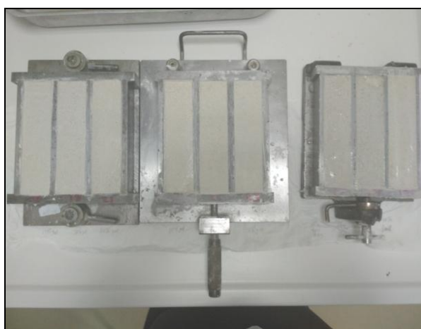
Εικόνα 4.19: Τελική τοποθέτηση υλικού στις μήτρες
