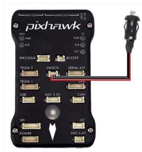
Εικόνα 2. Διακόπτης ασφαλείας ελεγκτή πτήσης
