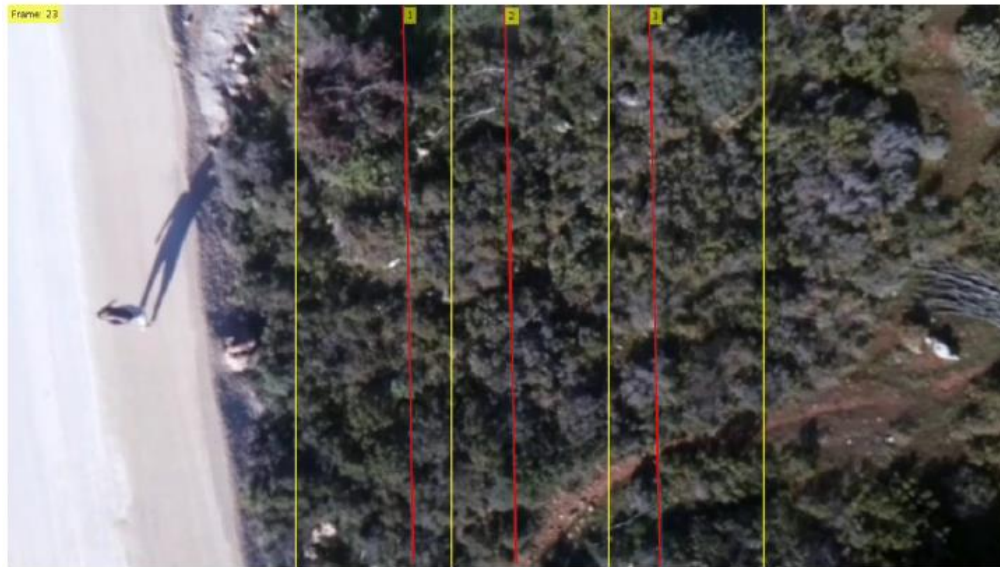
Εικόνα 32. Στιγμιότυπο 1 επεξεργασίας βίντεο (Εντοπισμένα καλώδια με κόκκινο χρώμα, όρια ROIs με κίτρινο χρώμα)
