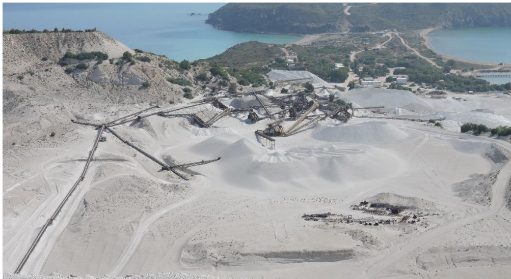
Εικόνα 4.5: Άποψη της παραγωγής (μεταφορικές ταινίες, σπαστήρες και κόσκινα) και των σωρών απόθεσης της παραγόμενης κίσης από την εκμετάλλευση
