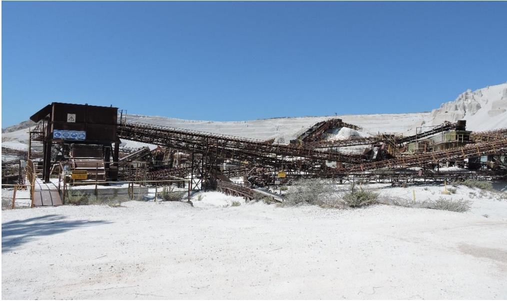
Εικόνα 4.4: Άποψη των εγκαταστάσεων παραγωγής (μεταφορικές ταινίες, σπαστήρες και κόσκινα) από την είσοδο του λατομείου
