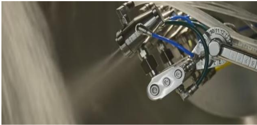
Εικόνα 15: Μπέκ ψεκασμού δισκίων
