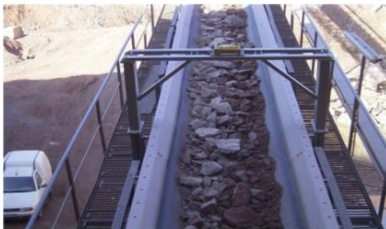
Εικόνα 2.6. Σύστημα προσδιορισμού παροχής και υγρασίας με χρήση αισθητήρα μικροκυμάτων, τύπου LB 442 bulk flow system ( https://www.berthold.com/ ).
