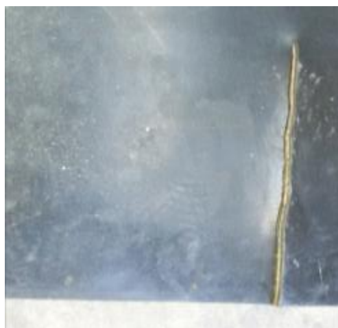
Εικόνα 4.9. Χαρτογράφηση μετρήσεων Lidar για ιμάντα που φέρει τεχνητό σκίσιμο. Διακρίνεται το τεχνητό σχίσσιμο που πραγματοποιήθηκε στον ιμάντα.
