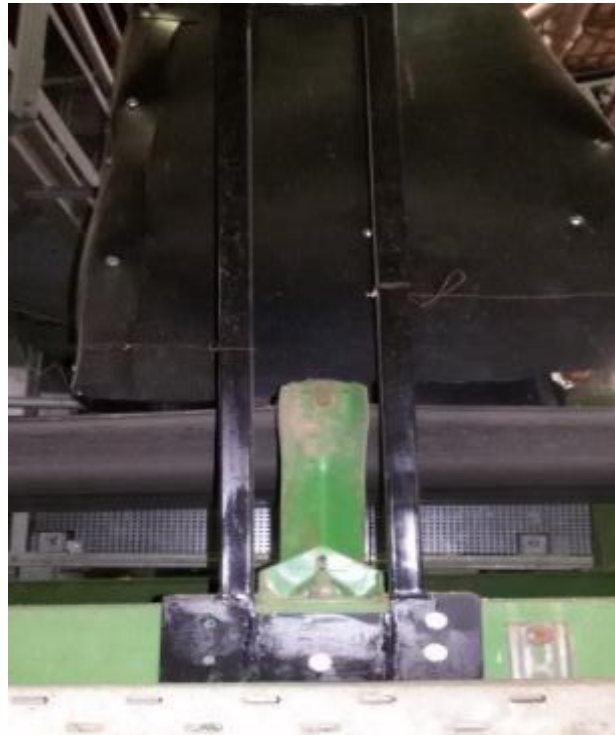
Εικόνα 3.9. Τοποθέτηση θαλάμου συμμετρικά του ραουλοσταθμού του ταινιόδρομου (πλάγια όψη).
