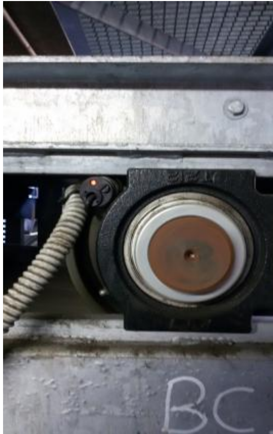
Εικόνα 2.4. Σταθερά τοποθετημένο επαγωγικό αισθητήριο για την μέτρηση της ταχύτητας κίνησης του ιμάντα (Εργοστάσιο μηχανικής διαλογής και κομποστοποίησης, ΔΕΔΙΣΑ-Χανιά).
