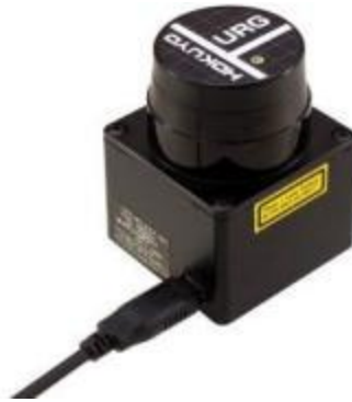
Εικόνα 3.2. Αισθητήρας Lidar/URG-04LX-UG01.
