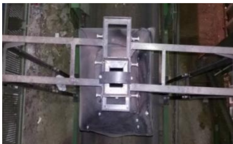
Εικόνα 3.10. Διάταξη ευθυγράμμισης θαλάμου μέτρησης με ιμάντα και υποβαστακτικούς κυλίνδρους (ράουλα) ταινιόδρομου (κάτοψη).
