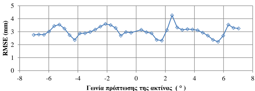
Εικόνα 4.3. Μεταβολή του μέσου τετραγωνικού σφάλματος σε σχέση με τη γωνία πρόσπτωσης της ακτίνας λέιζερ του Lidar.
