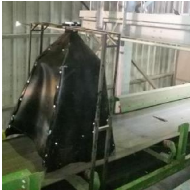
Εικόνα 3.4. Πειραματική διάταξη σκοτεινού θαλάμου για μετρήσεις με Lidar σε ταινιόδρομο BC-339A.
