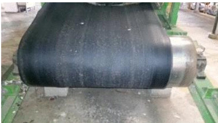
Εικόνα 2.1. Εκφυγή ιμάντα μεταφοράς που προέκυψε εξαιτίας της ανομοιογενούς κατανομής του υλικού επί της επιφάνειας του ιμάντα.
