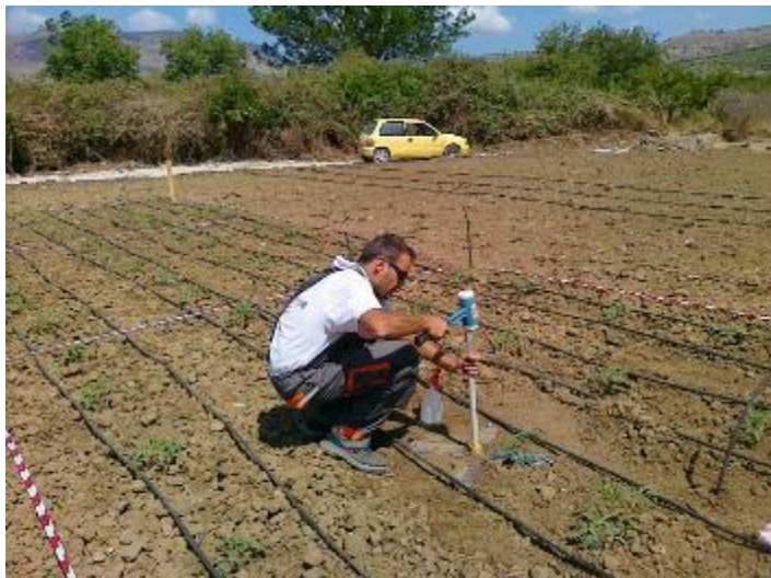
Εικόνα 3.6. Τοποθέτηση πλαστικών σωλήνων υποδοχής των υγρασιόμετρων.
