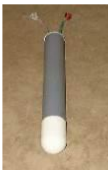
Εικόνα 3.7. Κεραμικό λυσίμετρο αναρρόφησης πορώδους εδαφικού διαλύματος (Εργαστήριο Υδρογεωχημικής Μηχανικής και Αποκατάστασης Εδαφών).
