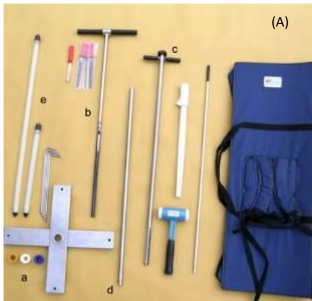
Εικόνα 3.5. (Α) Ολοκληρωμένο κιτ γεωτρημάτων για την τοποθέτηση των υγρασιόμετρων. Περιλαμβάνει (i) βάση σταθεροποίησης των τρυπανιών, (ii) τρυπάνι οδηγός, (iii) τρυπάνι τελειώματος, (iv) ράβδο και (v) πορώδης πλαστικοί σωλήνες, (Β) Υγρασιόμετρο τύπου PR2 Profile Probe, Delta-T Devices.
