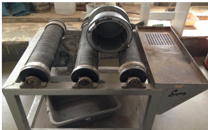
Εικόνα 6.7: Εργαστηριακός Σφαιρόμυλος με το σύστημα περιστροφής.
