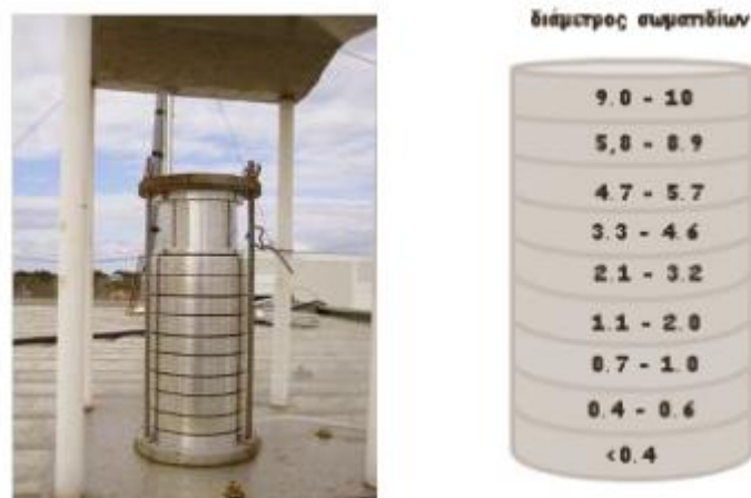
Σχήμα 2. 3: Andersen Cascade Impactor και εύρος τιμών κάθε σταδίου
