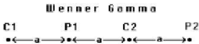
Σχήμα 2.7: Διάταξη Wenner Gamma, όπου C_{1,2} = ηλεκτρόδια ρεύματος και P_{1,2} = ηλεκτρόδια δυναμικού
