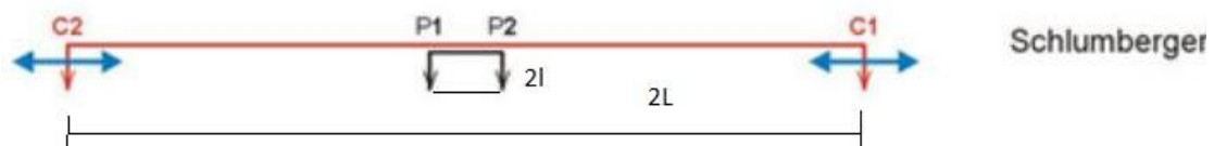
Σχήμα 2.8: Διάταξη Schlumberger, όπου C_{1,2} = ηλεκτρόδια ρεύματος A,B και P_{1,2} = ηλεκτρόδια δυναμικού M,N.
