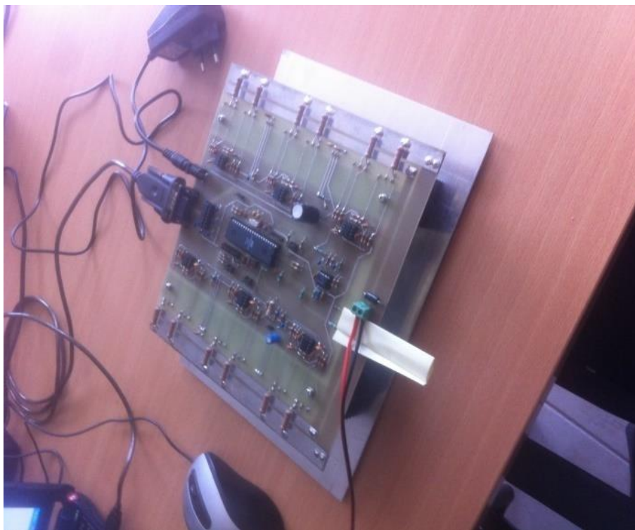
Εικόνα 6 Διάταξη I-V tracer
