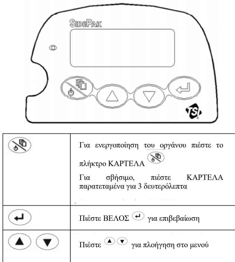
Εικόνα 15: Όργανο καταγραφής δεδομένων έκθεσης. Μοντέλο Sidepak AM510.
