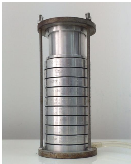
Εικόνα 14: Κρουστικός δειγματολήπτης Andersen εννιά αλληπάλληλων σταδίων.
