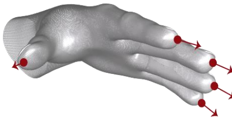
Εικόνα 37: Τα σύμβολα "TipPosition" και "Direction" του δακτύλου παρέχουν τη θέση ενός άκρου δακτύλου και τη γενική κατεύθυνση στην οποία δείχνει ένα δάχτυλο.
