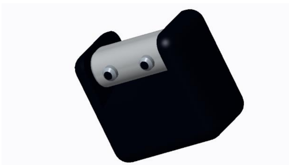
Συναρμολόγηση αισθητήρα υπερήχων.
