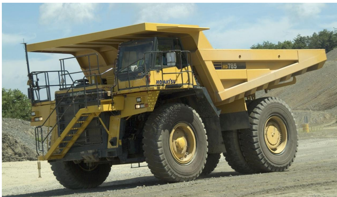
Σχ. 19: Χωματουργικό όχημα οπίσθια ανατροπής (βαρέως τύπου)(Komatsu 785-7) ( http://www.archiexpo.com/prod/komatsu-hanomag-gmbh/product-92858-1744491.html )
