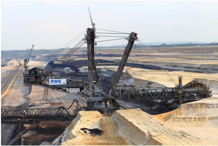
Σχ. 1: Καδοφόρος εκσκαφέας σε υπαίθρια εκμετάλλευση κατά λωρίδες σε κοίτασμα λιγνίτη ( Wikipedia ).
