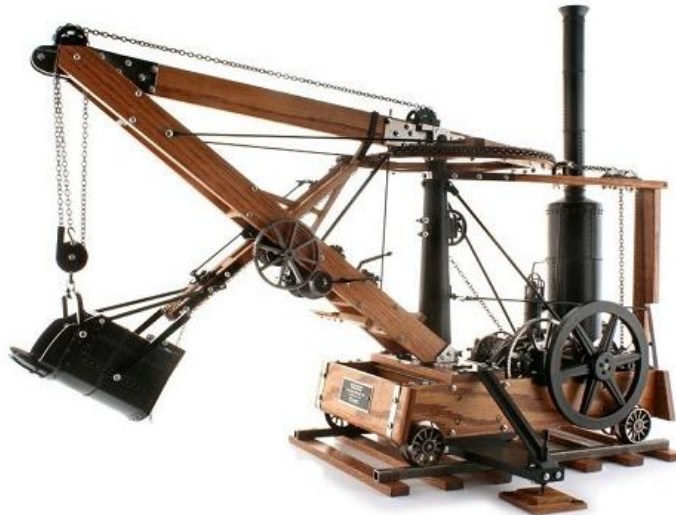
Σχ. 7: Εκσκαφέας με κάδο κατασκευής Ottis (1832).
