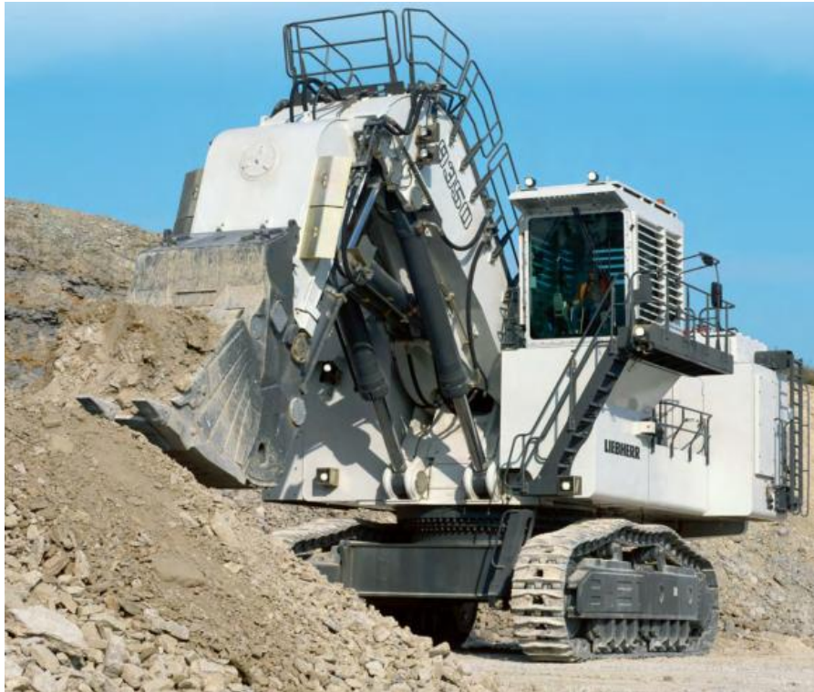
Σχ. 33: Υδραυλικός εκσκαφέας μετωπικού κάδου LIEBHERR (R9350) ( εγχειρίδιο LIEBHERR R9350 ).
