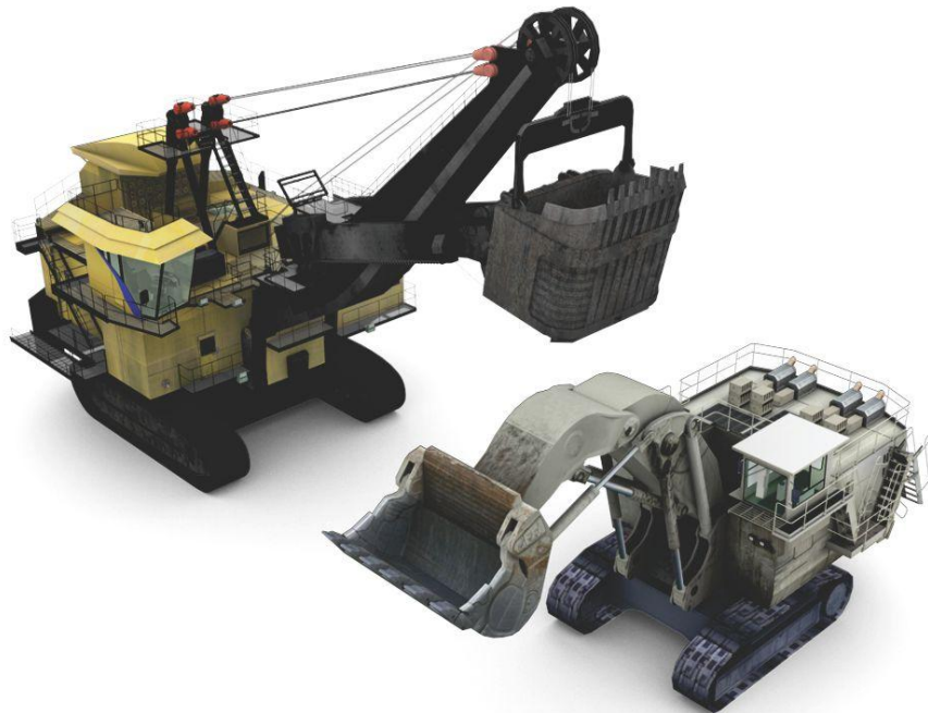
Σχ. 11: Μηχανικός εκσκαφέα (αριστερά) και υδραυλικός εκσκαφέα (δεξιά)( http://www.5dt.com/shovel-training-simulators/ ).
