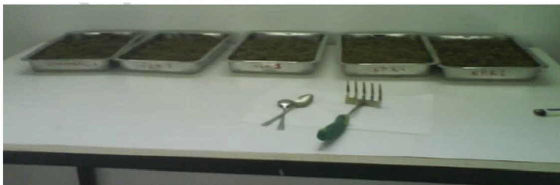
Εικόνα 3: Ταψάκια με ρυπασμένο χώμα κατά την εκτέλεση Biotreatability Study
