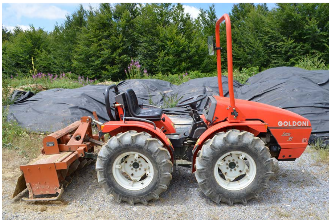
Εικόνα 10: Το τρακτέρ με φρέζα που χρησιμοποιήθηκε για την ανάμιξη του χώματος
