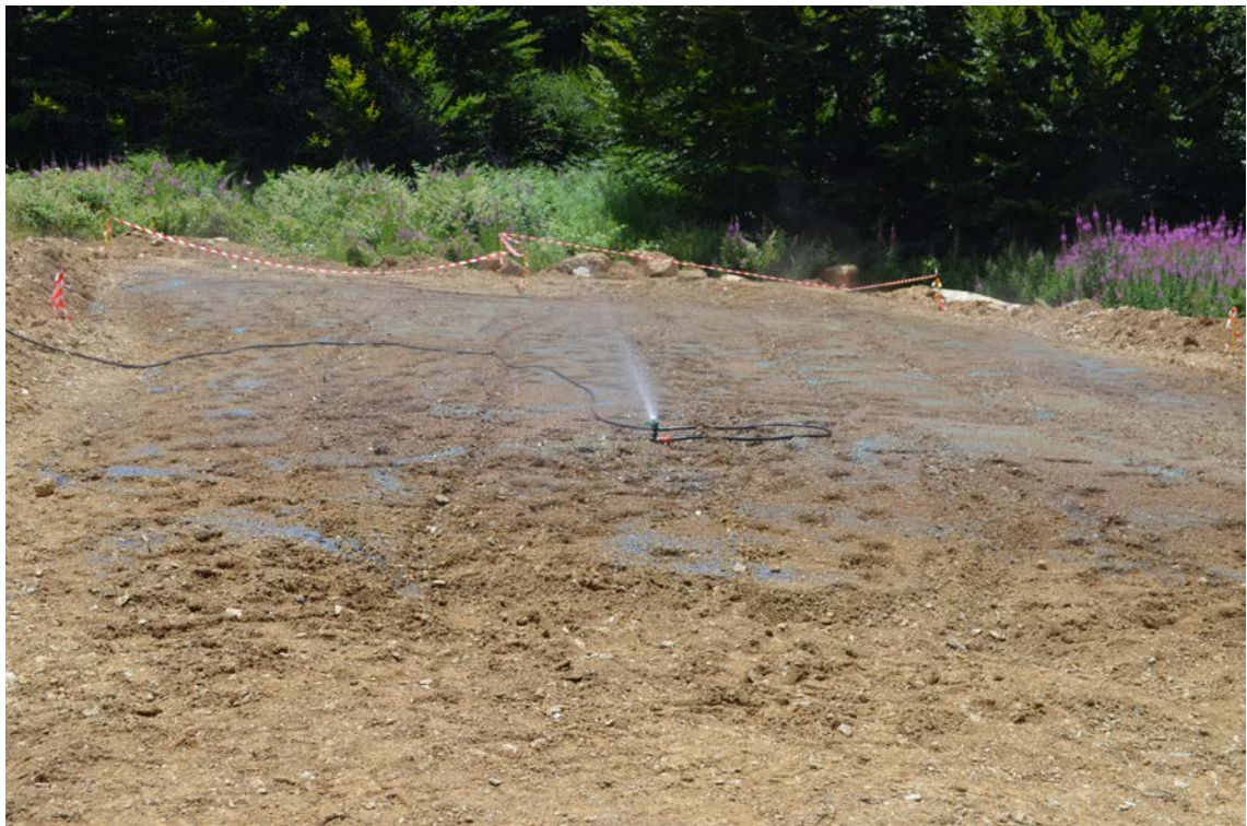
Εικόνα 12: Σύστημα τεχνητής βροχής που χρησιμοποιήθηκε
