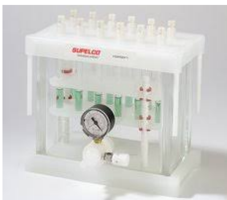
Εικόνα 19: Διάταξη εκχύλισης στερεάς φάσης (SPE)
