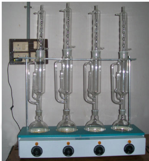
Εικόνα 18: Διάταξη από 4 συσκευές Soxhlet για ταυτόχρονη επεξεργασία δειγμάτων
