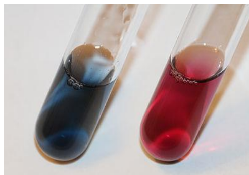
Εικόνα 48: Χημικός τύπος του Eriochrome Black T. και τα χρώματα του ανάλογα με το pH
