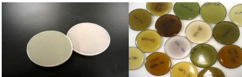
Εικόνα 13: Τήγματα σε μορφή δισκίων για την ανάλυση με XRF
