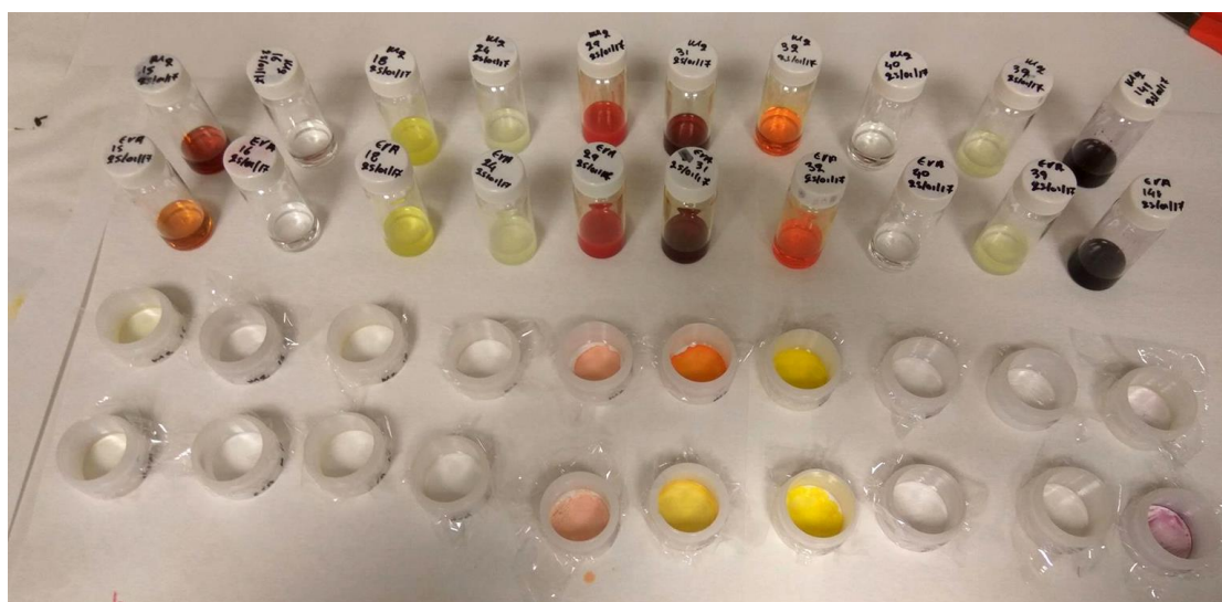
Εικόνα 44: Διαλύματα εκλεκτικών μεμβρανών και cups που περιέχουν τις μεμβράνες
