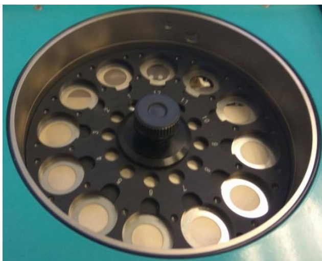
Εικόνα 45: Δειγματοφορέας Μηχανήματος ανάλυσης XRF
