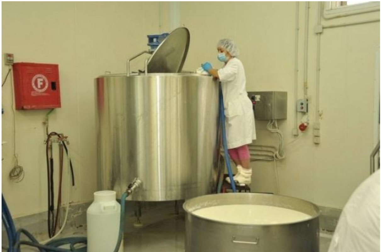
Εικόνα 10. Φωτογραφία κεντρικής εγκατάστασης εργοστασίου με απεικόνιση της δεξαμενής αποθήκευσης του γάλακτος πριν το στάδιο παστερίωσης του.
