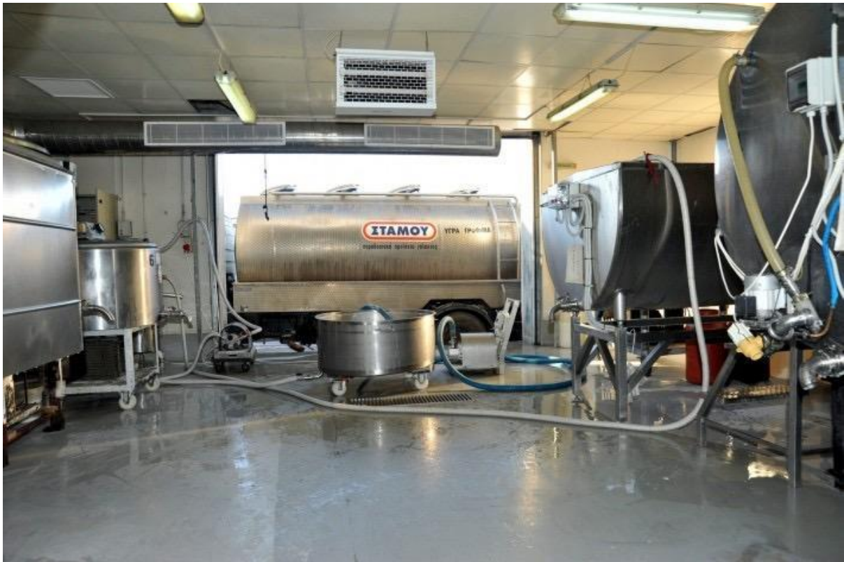
Εικόνα 9. Φωτογραφία κεντρικής εγκατάστασης εργοστασίου με απεικόνιση του φυγοκεντρικού διαχωριστήρα (αριστερά), του εταιρικού βυτίου (κέντρο) και της δεξαμενής αποθήκευσης γάλακτος (δεξιά).
