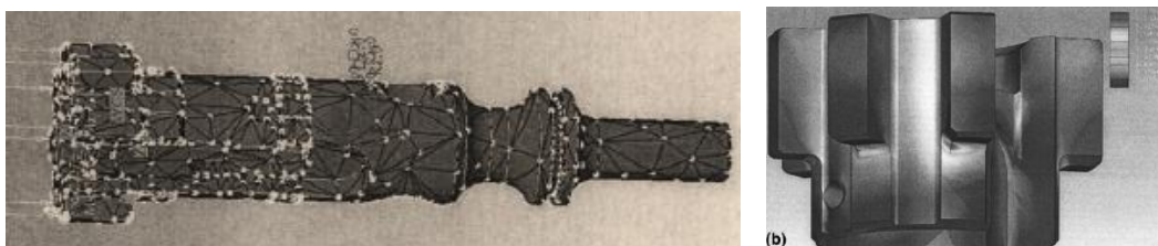
Σχήμα 76. Προσομοίωση πεδίου τάσεων της κεφαλής του κλειστρου που αποδεικνύει τη συγκέντρωση τάσεων στο οδοντωτό μέρος του δομικού στοιχείου.
