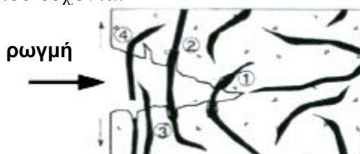
Σχήμα 48. (1) Ανέπαφη ίνα (2) Ίνα εκτός μήτρας (3) Αποκόλληση ίνας (4) Θραύση ίνας
