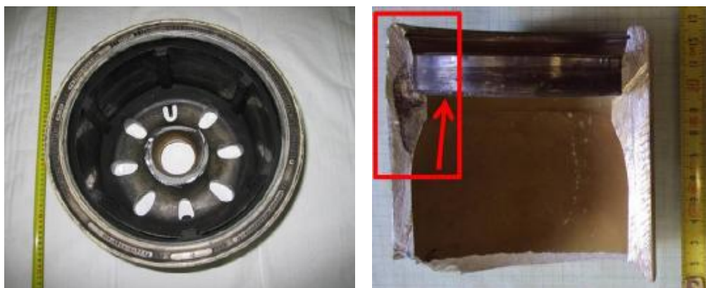
Σχήμα 85. Τροχός αεροσκάφους και θραυσμένο τμήμα αυτού
