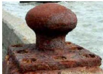
Σχήμα 30. Παράδειγμα ομοιόμορφης διάβρωσης
