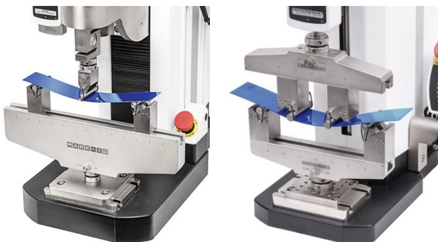
Σχήμα 64. Εξοπλισμός δοκιμής τριών και τεσσάρων σημείων
