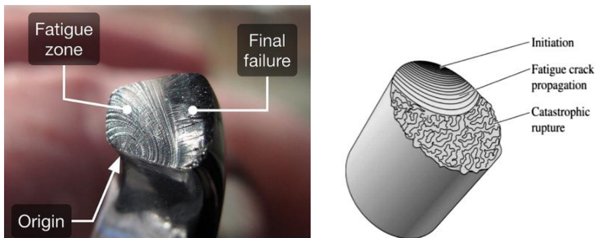
Σχήμα 27. Μηχανισμός της κόπωσης σχηματικά δεξιά και παράδειγμα θραύσης λόγω κόπωσης αριστερά
