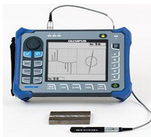
Σχήμα 60. Τεχνική ελέγχου με δινορεύματα (β) Ενδεικτικός εξοπλισμός
