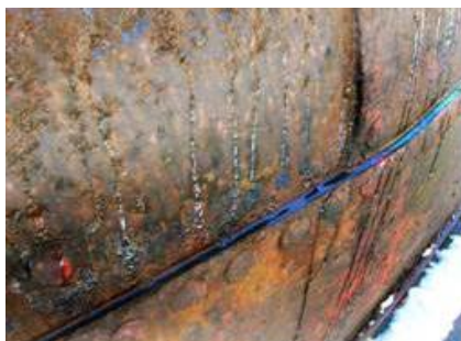
Σχήμα 30. Παράδειγμα ομοιόμορφης διάβρωσης
