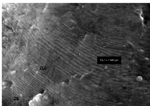
Σχήμα 88. Ραβδώσεις κόπωσης στην περιοχή 1
