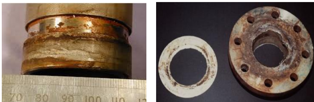
Σχήμα 33. Παραδείγματα διάβρωσης χαραγών ή ρωγμών σε αγωγό και μεταλλικό δακτύλιο
