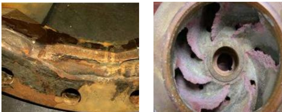
Σχήμα 37. Παραδείγματα διάβρωσης εκ τριβής
