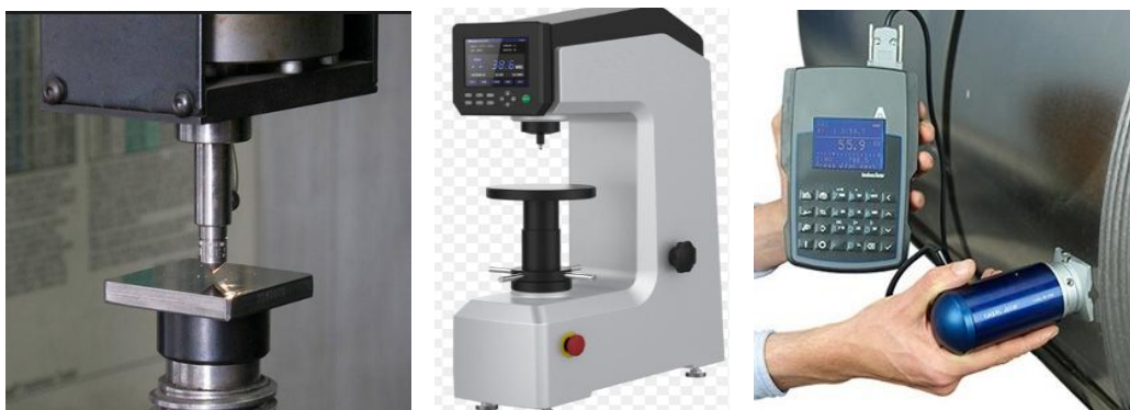
Σχήμα 62. Παραδείγματα σταθερών και φορητών οργάνων σκληρομέτρησης
