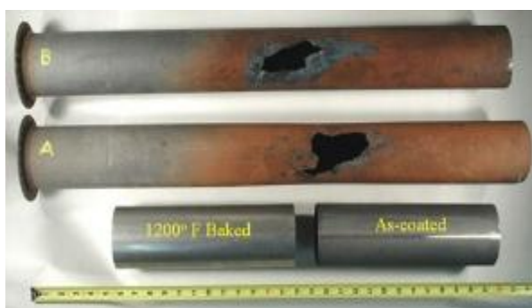
(α) Σύγκριση με αρχική μορφή αγωγού (β) Εσωτερική επιφάνεια αγωγού Σχήμα 40. Παράδειγμα διάβρωσης αγωγών αλουμινίου σε υψηλή θερμοκρασία
