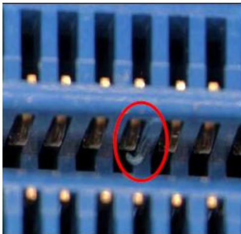
Σχήμα 91. Οπτικό μικροσκόπιο: (α) απόξεση στα περιβλήματα των pins στις ηλεκτρικές επαφές (β) σημάδια φθοράς στο housing body των memory modules
