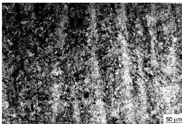
Σχήμα 82. Μικροδομή δείχνοντας τη «banded» δομή αποτελούμενη από «tempered martensite and bainite»
