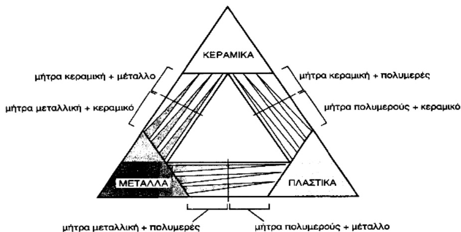
Σχήμα 10. Συνδυασμοί επιμέρους κατηγοριών υλικών σε σύνθετα υλικά
