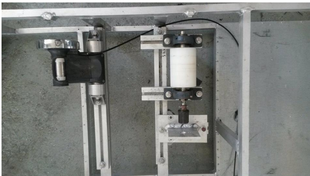
Σχήμα 6: Κάτοψη της βάσης όπου φαίνεται η τοποθέτηση του εργομέτρου ποδηλάτων
