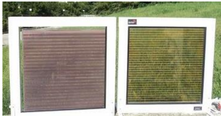
Εικόνα 1 : Το φωτοβολταϊκό πλαίσιο τύπου Dye-Sensitized που χρησιμοποιήθηκε [5].
