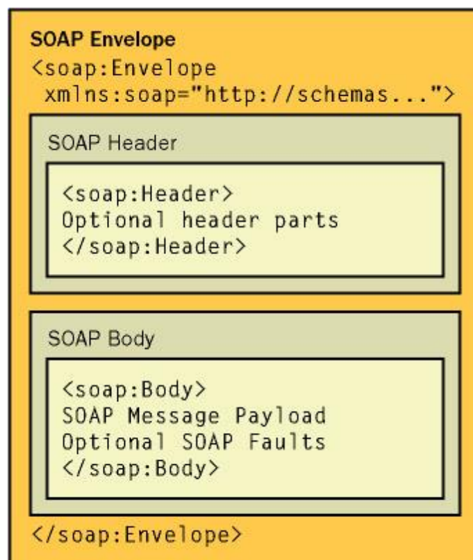
Εικόνα 5: Δομή μηνυμάτων στο SOAP
