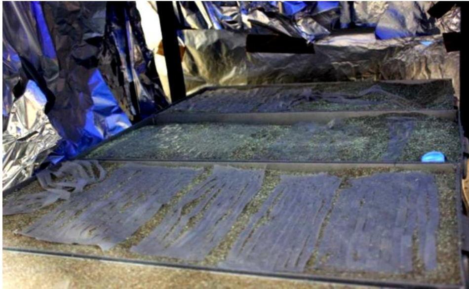
Εικόνα 8: HDPE φιλμ σε άμμο με UV-A ακτινοβολία
