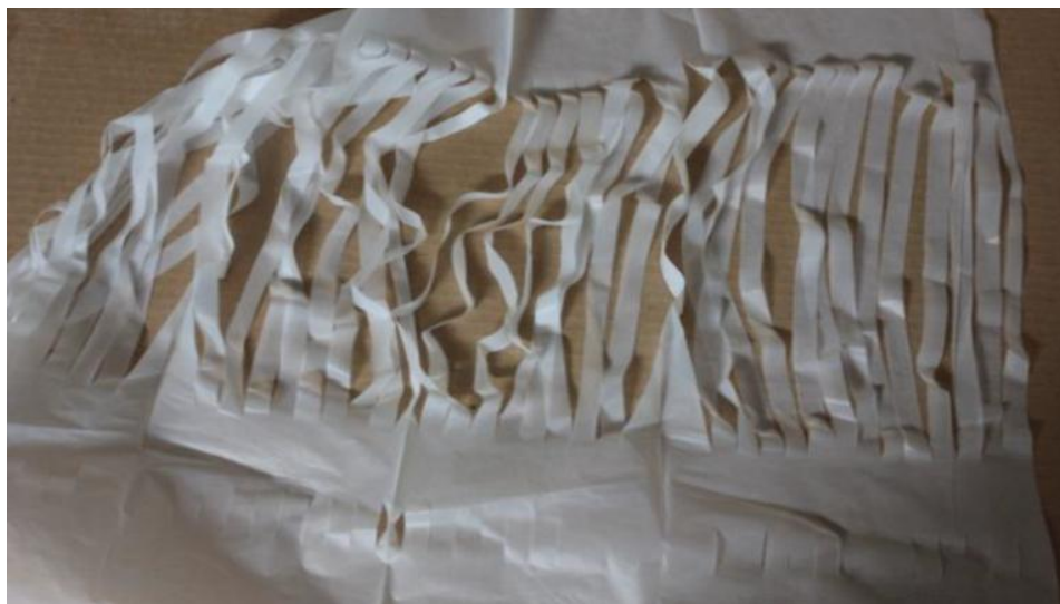
Εικόνα 7: Φιλμ πλάτους 1cm, μήκους περίπου 9 cm και πάχος 0,1mm
