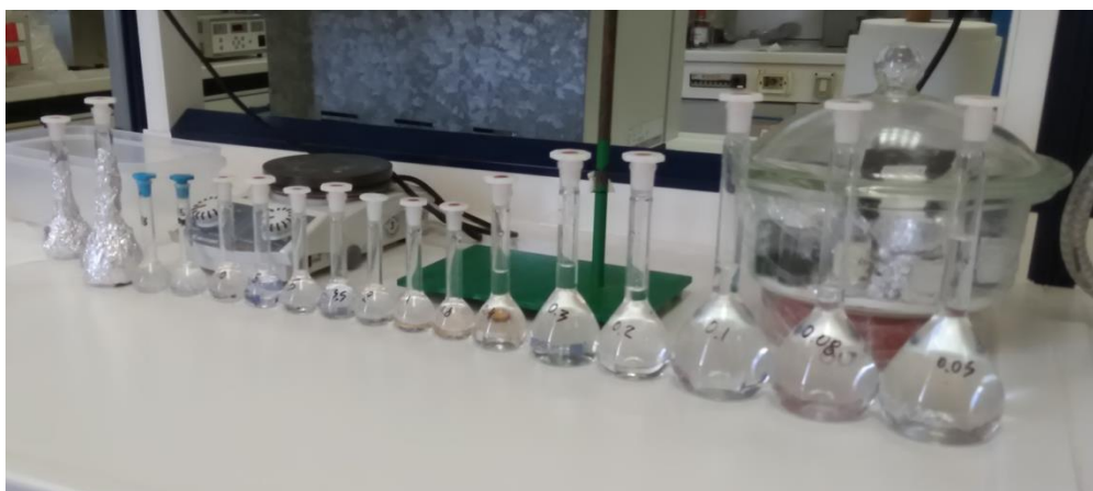
Εικόνα 3.3. Παρασκευασμένα διαλύματα γνωστών συγκεντρώσεων για την βαθμονόμηση της HPLC
