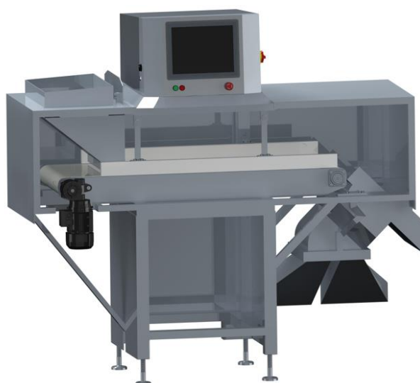
Εικόνα 4.44: Τοποθέτηση Πλαϊνών Λαμαρινών Καλ. Στη Βάση
