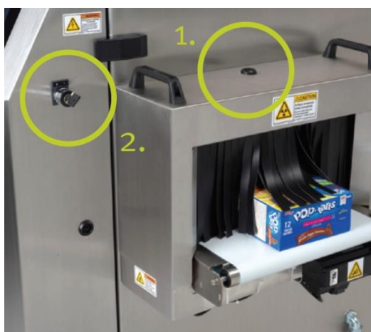
Εικόνα 3.29: 1.Κλειδί απομάκρυνσης λαμαρινών για συντήρηση 2. Κλειδί ενεργοποίησης Σ.Ε.Α.Χ
