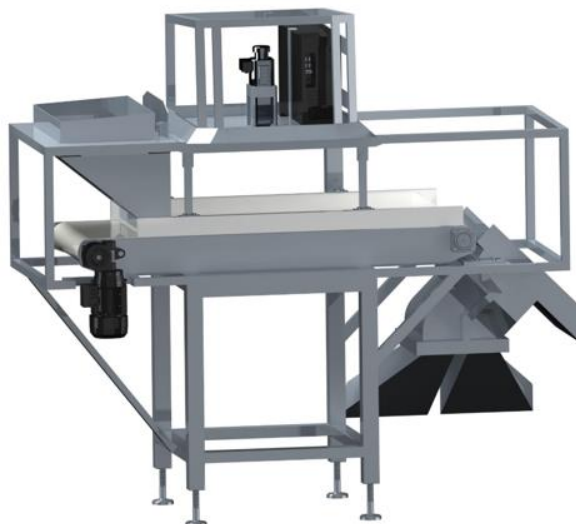
Εικόνα 4.30: Τοποθέτηση Ακτινοβολέα, Ανιχνευτή & Η/Υ στη Βάση Σ.Ε.Α.Χ
