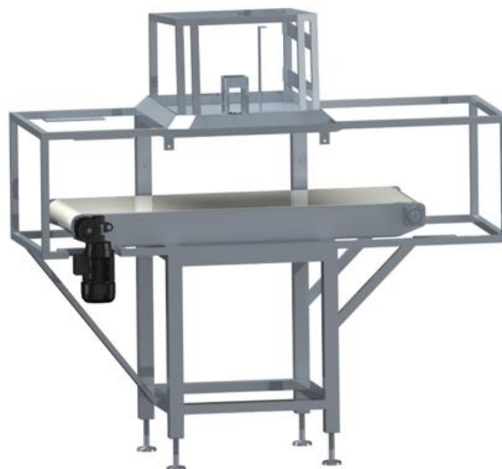
Εικόνα 4.13: Τοποθέτηση Ιμάντα Μεταφοράς στη Βάση Σ.Ε.Α.Χ
