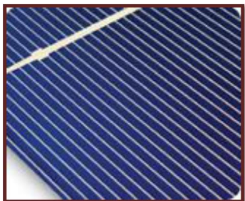
Εικόνα 2.7: Κύτταρο Μονοκρυσταλλικού πυριτίου
