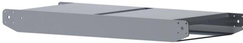
Εικόνα 4.10: Σχεδιασμός βάσης Ιμάντα μεταφοράς
