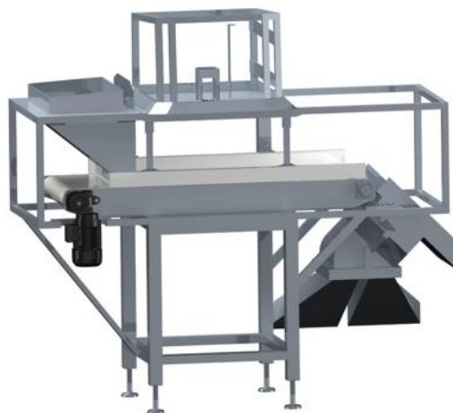
Εικόνα 4.26: Τοποθέτηση Διαχωριστήρα στη Βάση Σ.Ε.Α.Χ τα 8
