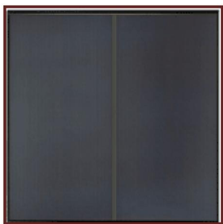
Εικόνα 2.9: Κύτταρο άμορφου Πυριτίου
