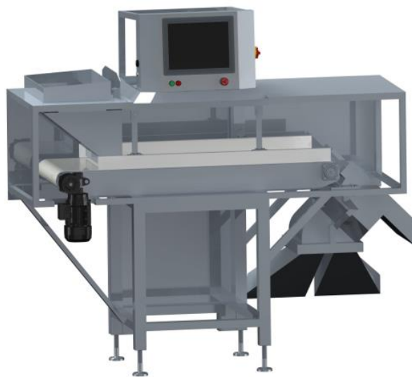
Εικόνα 4.39: Τοποθέτηση Οπίσθιων Λαμαρινών Καλ. Στη Βάση
