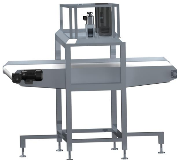
Εικόνα 4.61: Τοποθέτηση Ακτινοβολέα, Ανιχνευτή & Η/Υ στη Βάση Σ.Ε.Α.Χ
