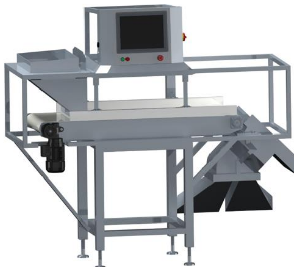
Εικόνα 4.34: : Τοποθέτηση Πίνακα Ελέγχου στη Βάση
