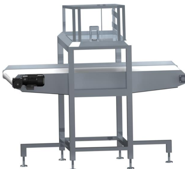
Εικόνα 4.60: Τοποθέτηση Ιμάντα Μεταφοράς στη Βάση Σ.Ε.Α.Χ
