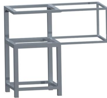
Εικόνα 4.5: Σχεδιασμός στήριξης Διαχωριστήρα
