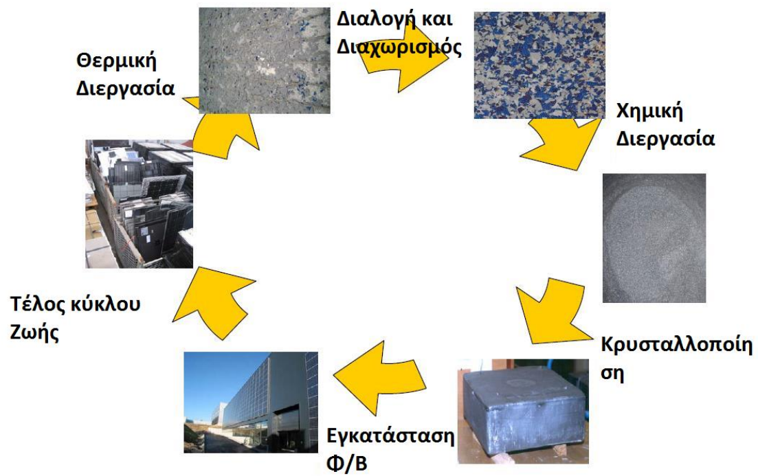
Εικόνα 2.23: Διαδικασία ανακύκλωσης Φ/Β πολυκρυσταλλικού πυριτίου
