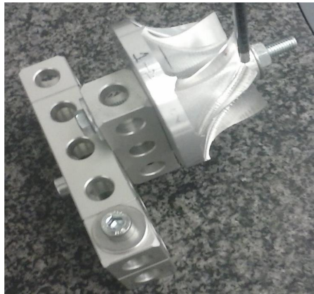
Εικόνα 5.11: Μέτρηση τραχύτητας της επιφάνειας αναρρόφησης.
