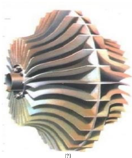
Εικόνα 1.5: Πτερωτή διπλής όψης
