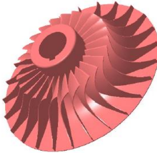
Εικόνα 1.6: Πτερωτή ακτινικής εξόδου
