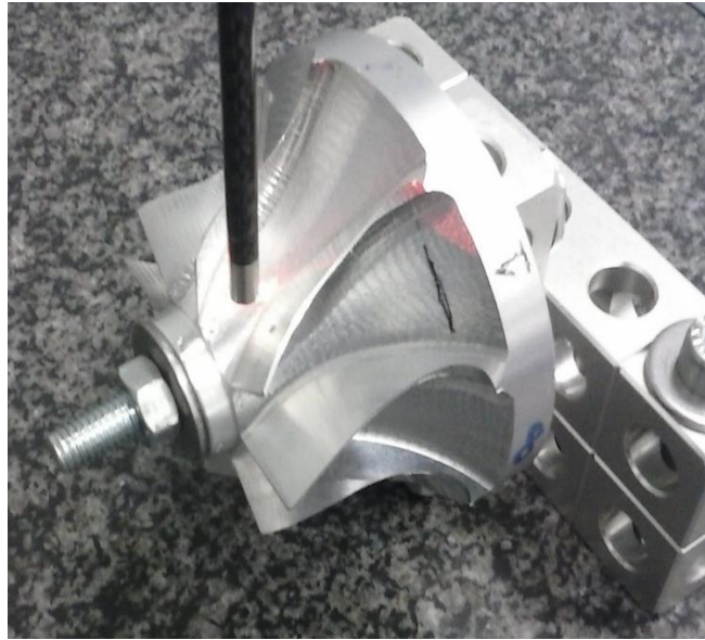
Εικόνα 5.12: Μέτρηση τραχύτητας της επιφάνειας πίεσης.
