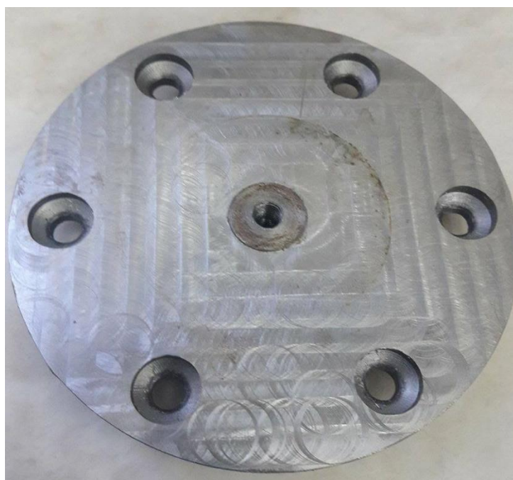
Εικόνα 2.7: Επάνω όψη της βάσης μετά την κατεργασία φρεζαρίσματος.
