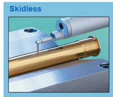
Εικόνα 5.8: Τραχύμετρο τύπου (skidless system)
