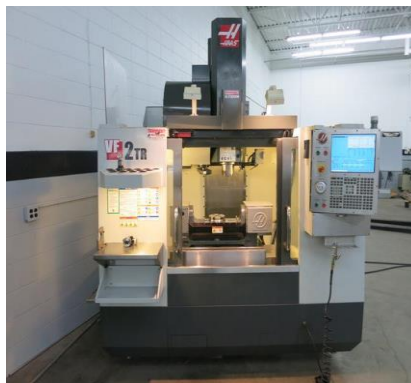
Εικόνα 1.21: Εργαλειομηχανή (3+2) αξόνων.
