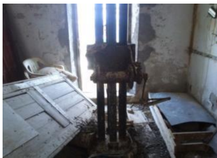
Εικόνα 55 Ο μηχανισμός της τροχαλίας που ανύψωνε το φωτιστικό μηχάνημα στο φάρο του Αγίου Νικολάου
