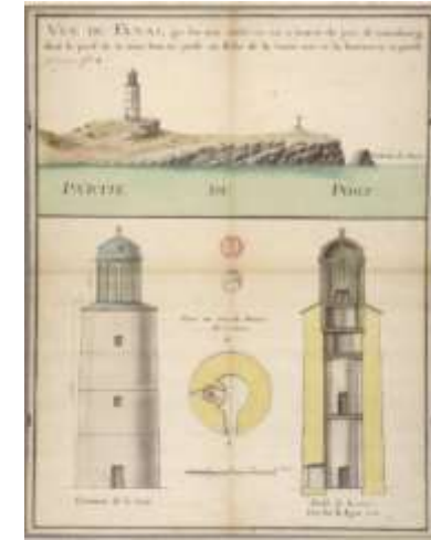
Εικόνα 4 Σχέδιο κατασκευής φάρου Fanal, Biblioteque de phares, Ecole de pontsParistech.
