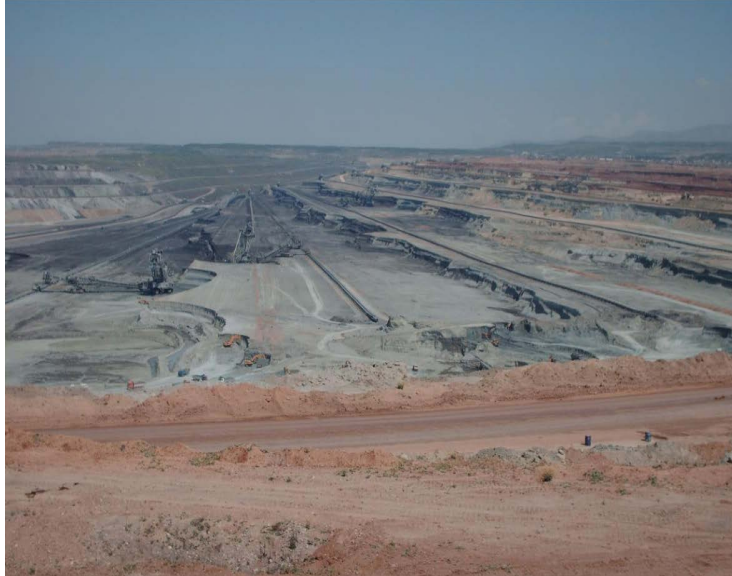
Εικ. 4: Επιφανειακό λιγνιτωρυχείο με καδοφόρους εκσκαφείς. Δεξιά είναι το κοίτασμα λιγνίτη και αριστερά οι αποθέσεις στείρων.
