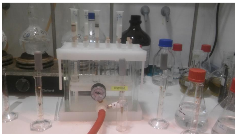
Εικόνα 27: Διάταξη εκχύλισης στερεής φάσης ( spe )
