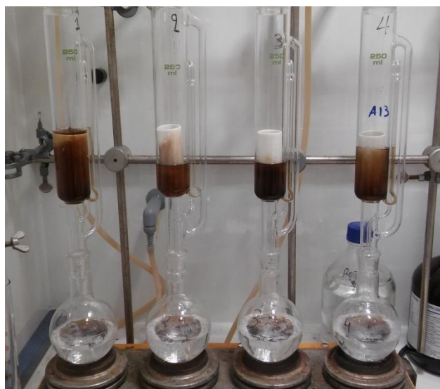
Εικόνα 26: Διάταξη εκχύλισης soxhlet
