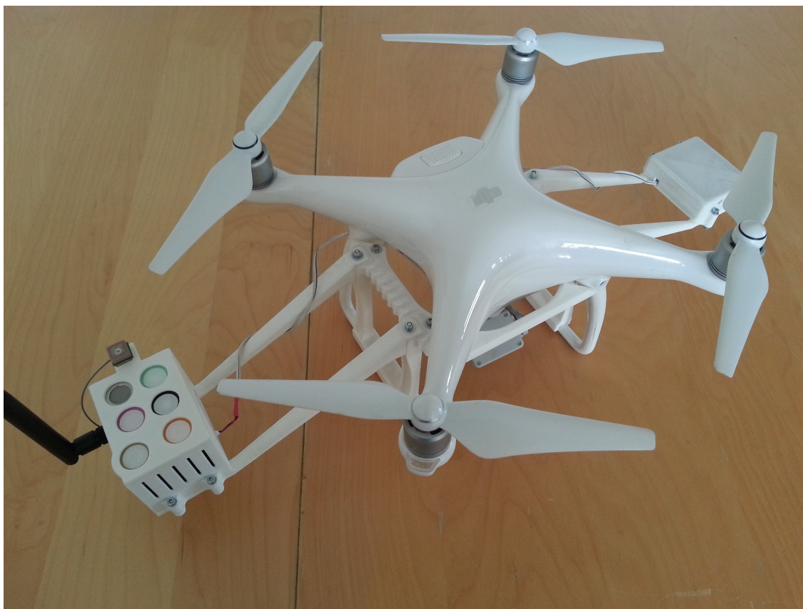
Εικόνα 2-29. Το ηλεκτρονικό σύστημα εγκατεστημένο στο αεροσκάφος.
