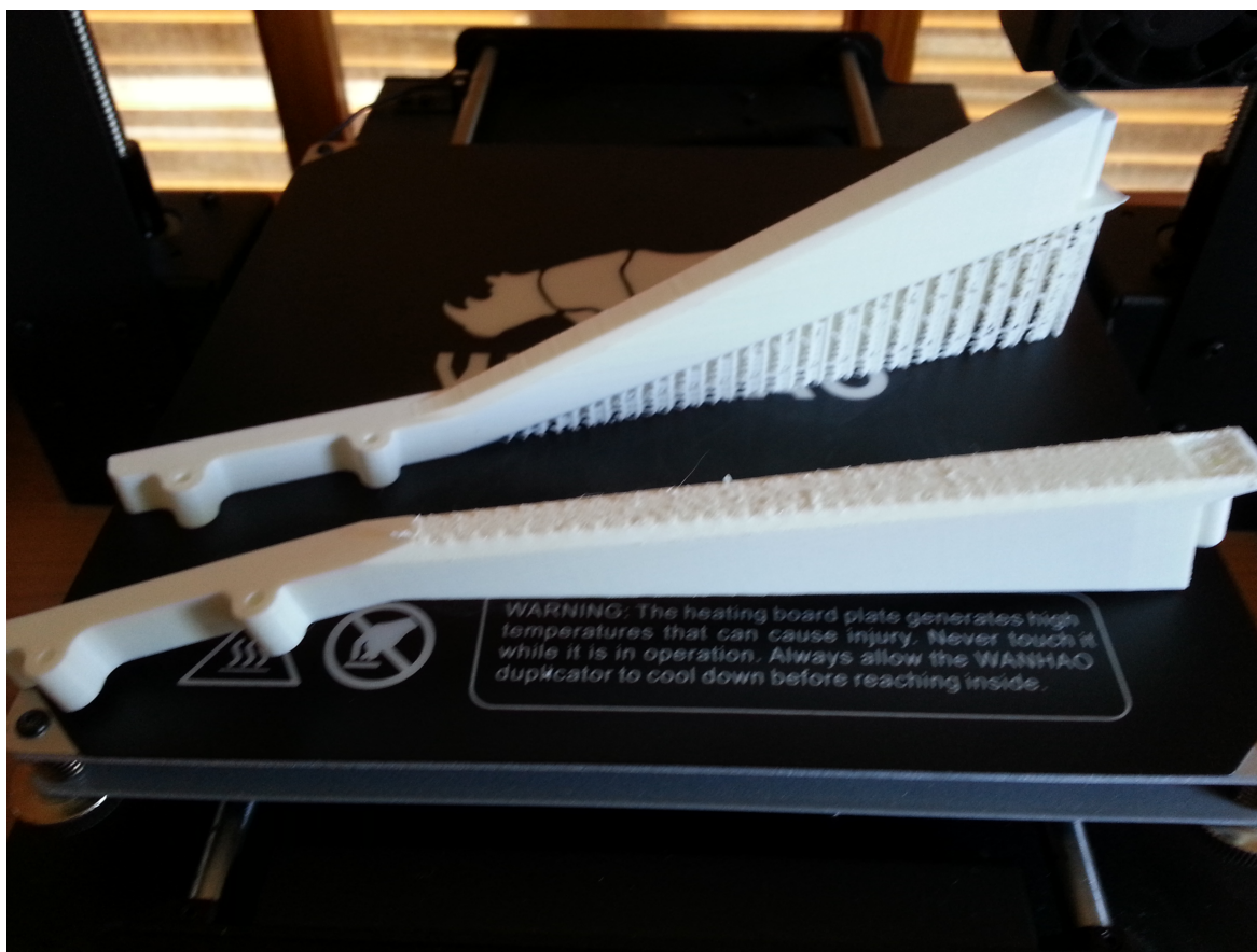
Εικόνα 2-20. Υλικό από την υποστήριξη που έχει προσκολληθεί την επιφάνεια του αντικειμένου.
