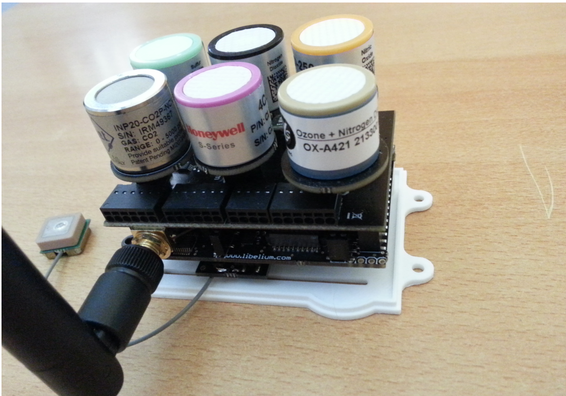
Εικόνα 2-26. Το ηλεκτρονικό σύστημα βιδωμένο στο κάτω μέρος του κουτιού.
