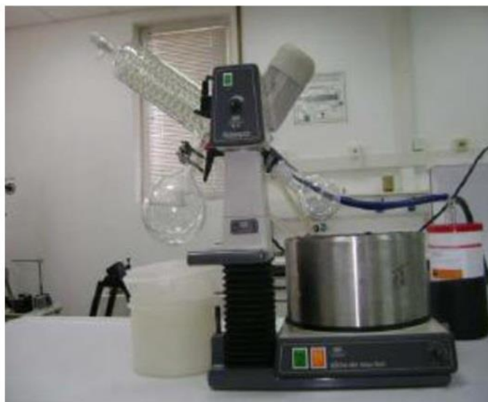
Σχήμα 5.7 Περιστροφικός εξατμιστήρας (rotary evaporator) (Εργαστήριο Ανάλυσης Πυρήνων και Υπόγειων Ταμιευτήρων).
