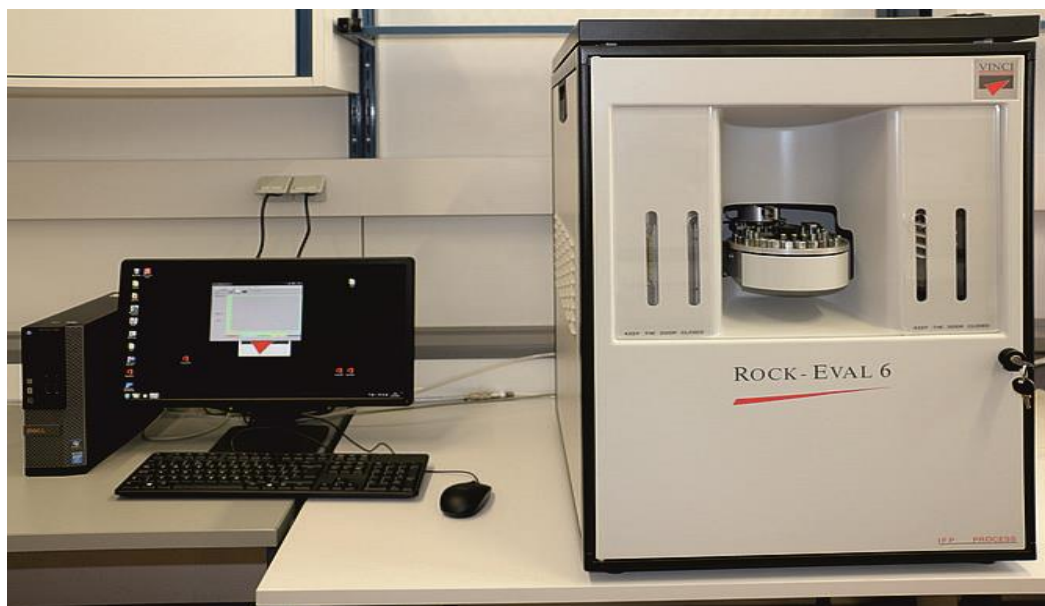
Σχήμα 5.1 Αναλυτικό όργανο Rock-Eval 6/TOC.
