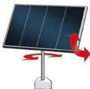
Εικόνα 2.8: Ιχνηλάτηση του ήλιου σε δυο άξονες
