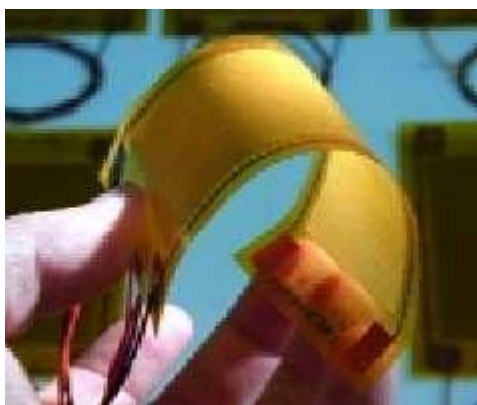
Εικόνα 23- Εύκαμπτη ταινία που περιέχει πιεζοηλεκτρικό υλικό
