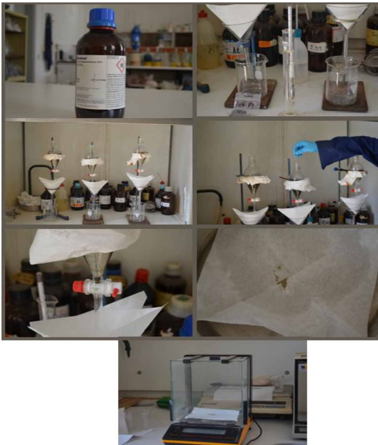
Εικόνα 3.4 Πειραματική διαδικασία για την συλλογή βαρέων ορυκτών
