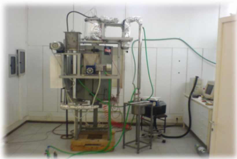
Εικόνα 3.1 Πειραματική διάταξη συστήματος ρευστοποιημένης κλίνης.
