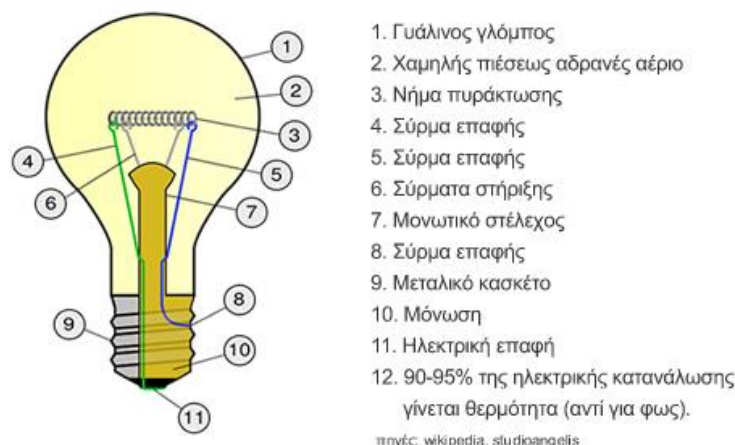
Σχήμα 2.2: Κατασκευαστικά μέρη λαμπτήρα πυράκτωσης.
