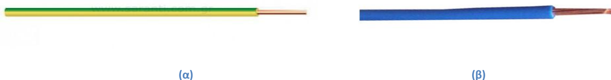
Εικόνα 3.1: (α) Διπλός χρωματισμός πράσινο - κίτρινο για τον αγωγό προστασίας (β) μονόχρωμο ανοιχτό μπλε για τον ουδέτερο αγωγό
