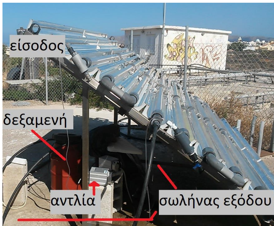
Εικόνα 3. 3: Αντιδραστήρας CPC: διάταξη του πειράματος
