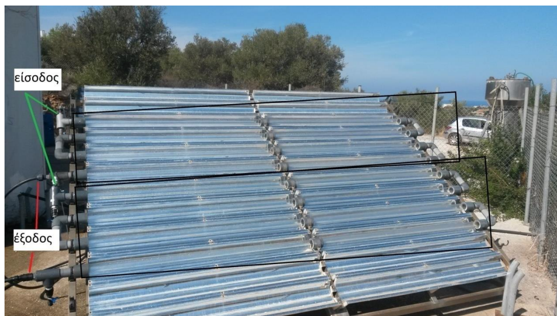
Εικόνα 3. 1: Ο αντιδραστήρας CPC. Φαίνονται οι 2 εισόδοι και εξόδοι και οι 2 ξεχωριστές διατάξεις
